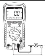
Garder les mains sous la garde en mesurant des niveaux de courant.
